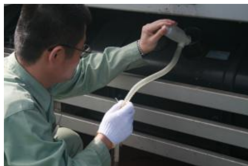
図4-1-1 軽油の抜き取り検査
