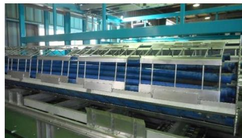
撤去したポリエチレン管の洗浄・殺菌設備
