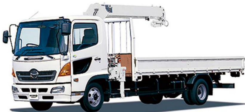
クレーン付きトラック
