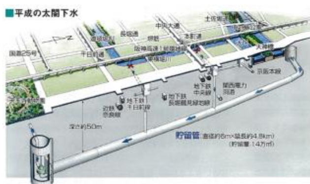
図 49 北浜逢阪貯留管（愛称：平成の 太閤下水）の概要（大阪市提供資料）
