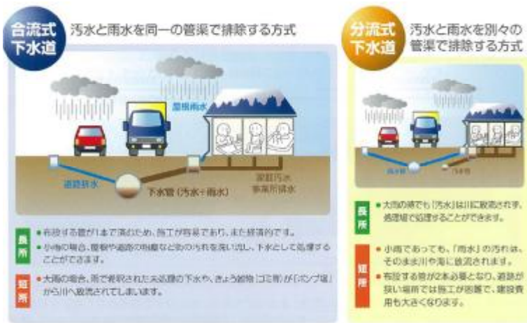
図1 合流式下水道と分流式下水道 （大阪府東部流域下水道事務所作成パンフレット）
