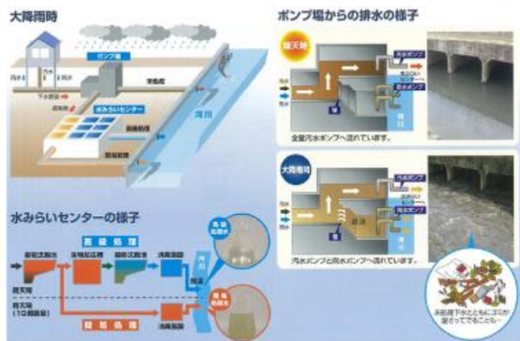
図2 合流式下水道における雨天時の下水処理（大阪府東部流域下水道事務所作成パンフレット）
