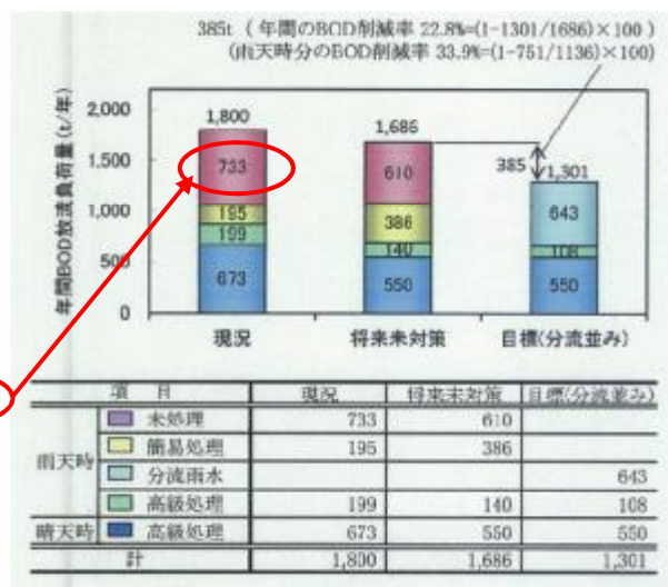
図6 合流式下水道における年間BOD負荷量と、分流式下水道を採用した場合に推計される年間BOD負荷量の比較(寝屋川北部流域下水道合流式下水道改善計画 平成22年3月)
