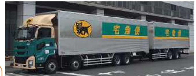
全長21mのフルトレーラー → トラックの大型化による輸送効率の向上
