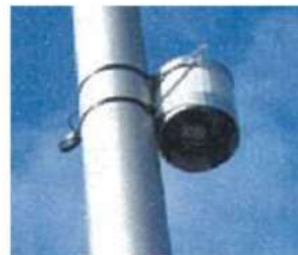
【簡易測定手法】 監視測定局よりも容易に多くの 地点に設置可能。
