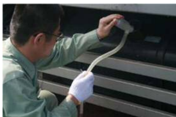
軽油の抜き取り検査
