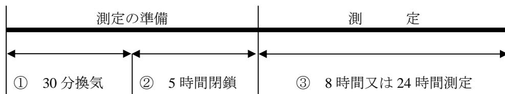
注：①②③において、換気設備又は空気調和設備は稼働させたままとする。ただし、局所的な換気扇等で常時稼働させないものは停止させたままとする。
