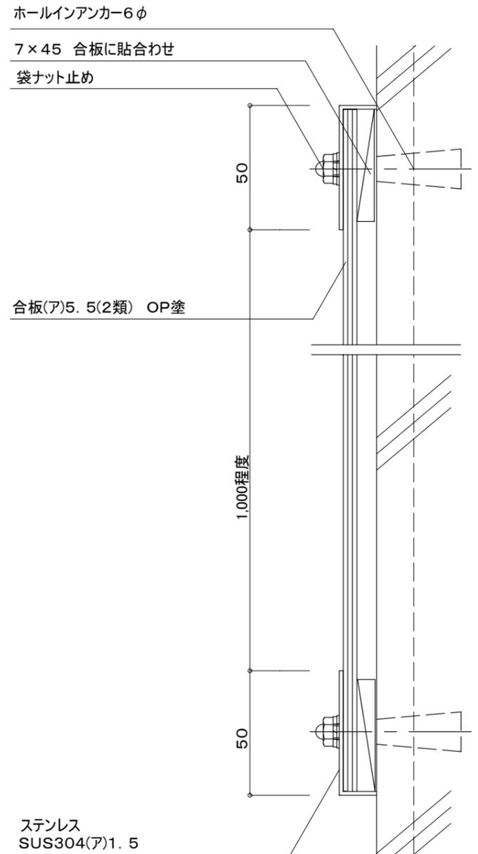
添付図⑭ 各部詳細図(点字板)
