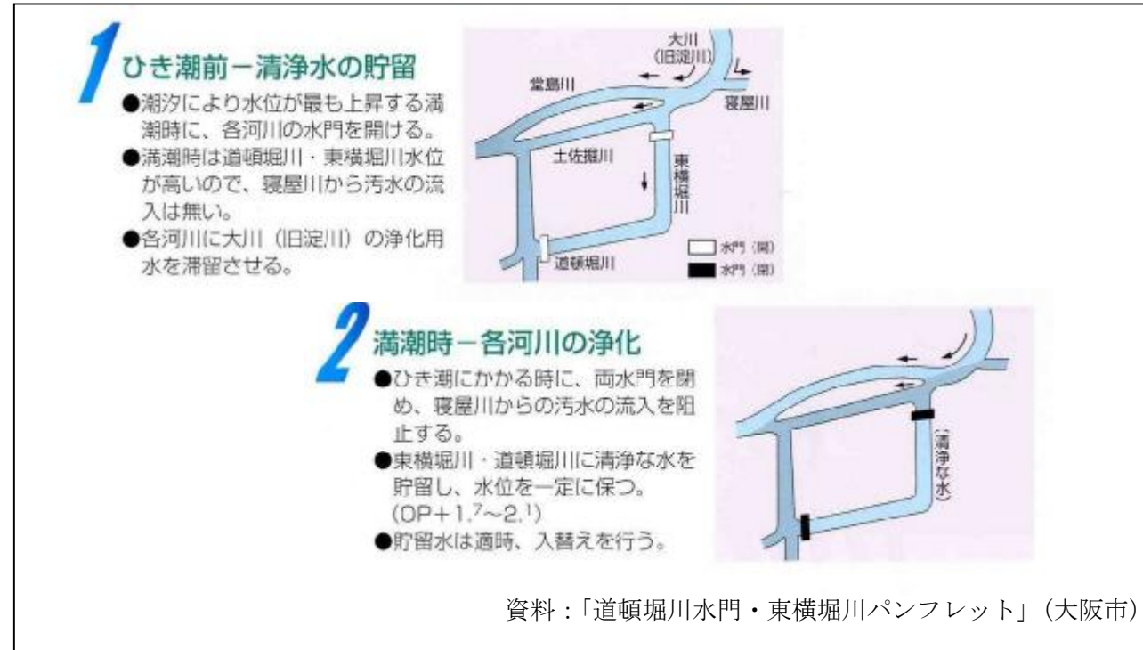
図 1.95 東横堀川・道頓堀川の水門制御概念
