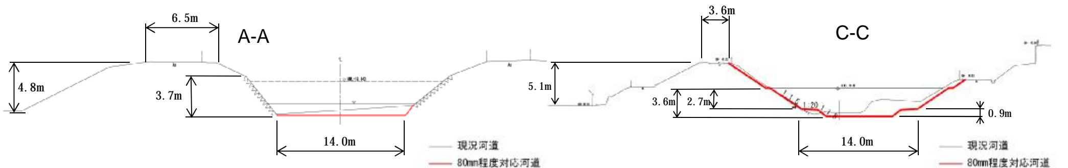
河道改修横断面図(河床掘削案)
