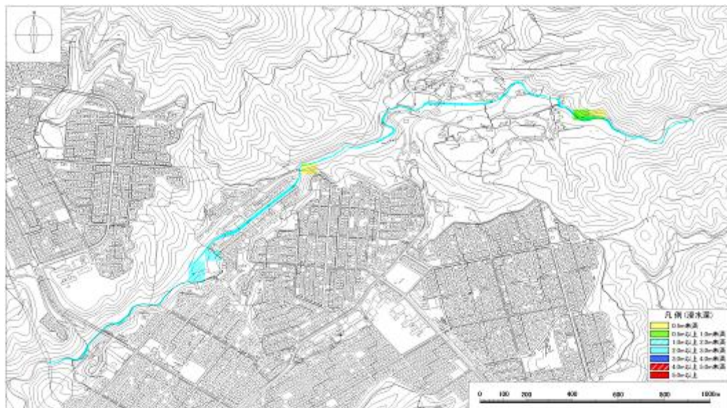
河川整備後 時間雨量 50 ミリ程度での氾濫解析結果（初谷川）
