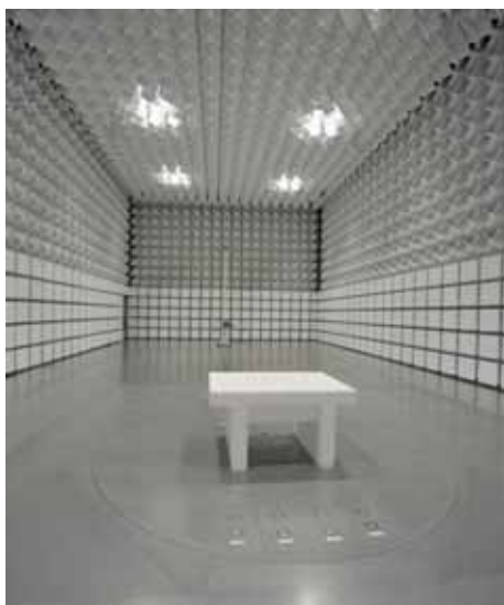
EMC技術開発支援センター 第1電波暗室(10m法対応)
