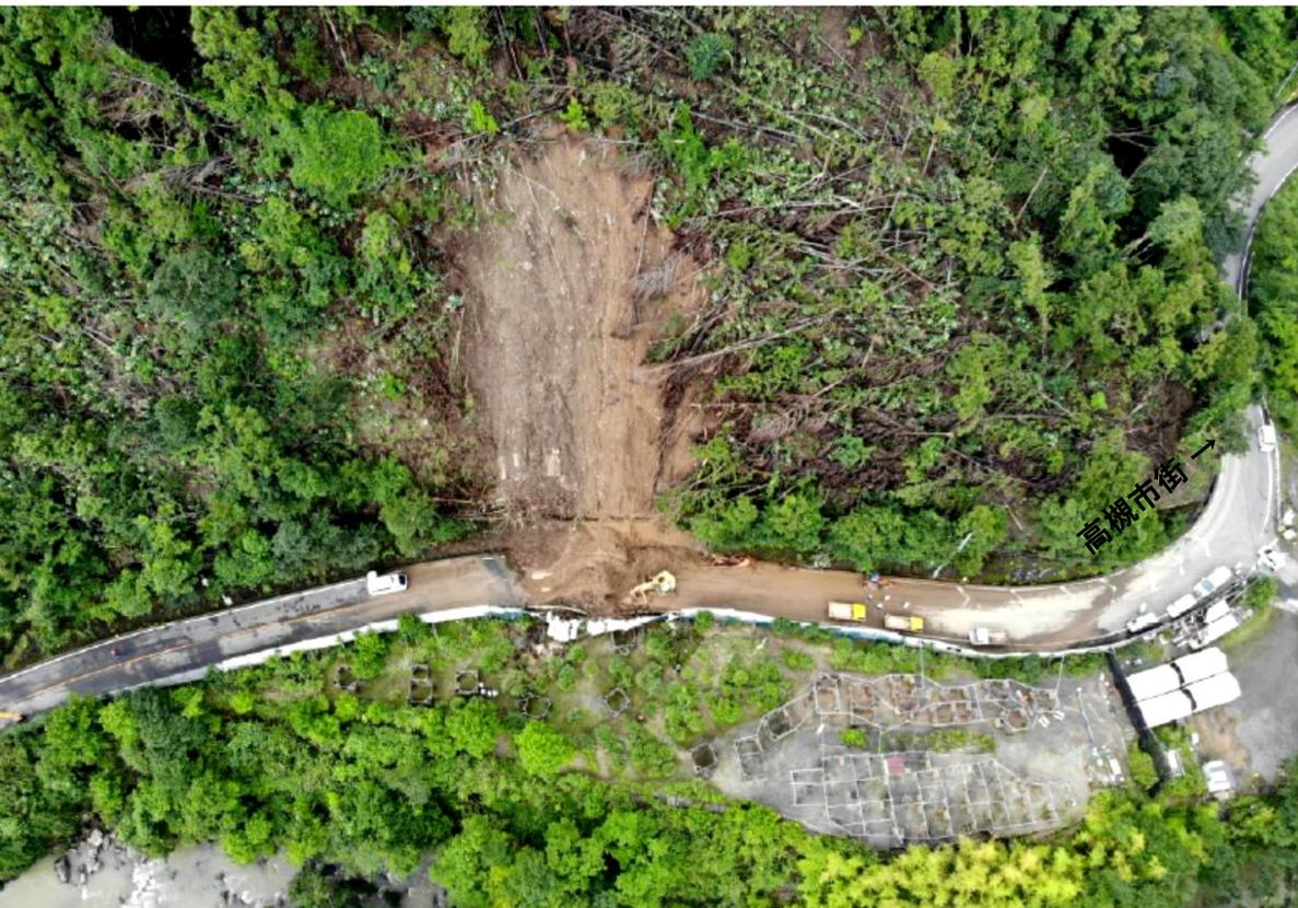
山側法面の土砂・倒木が崩落して2車線を延長約50メートルにわたって塞ぐとともに、道路を越えて谷側の私有地にも到達している。
