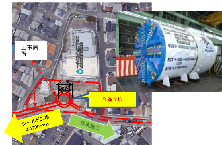
門真守口増補幹線（第1工区）下水管渠築造工事 （シールド工事の発進立坑）
