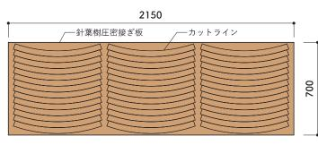
ベンチの座面の切り出しでは、圧密横接ぎ板を作成後、 NC 加工することで歩留と耐久性を向上させ、 材料のロスを極力小さくします。
