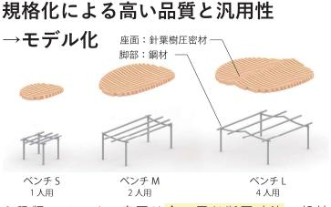
3 種類のベンチの座面は全て同じ断面寸法の部材 (35mm×40mm 程度)同じ曲率 R1000 とし、工場製作時 の効率と完成後のメンテナンス性の向上を図ります。座面 には圧密した針葉樹を、脚部には鋼材を用いることで維持 管理を容易にしつつ長く安心安全に使えるベンチとします。
