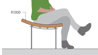
木の温もり、手触りを活かすベンチとするため座面にはヒ ノキを用います。平面形状だけでなく断面方向にも緩やか な円弧を用いることで、人の身体にフィットする利用者に 優しいベンチをつくります。
