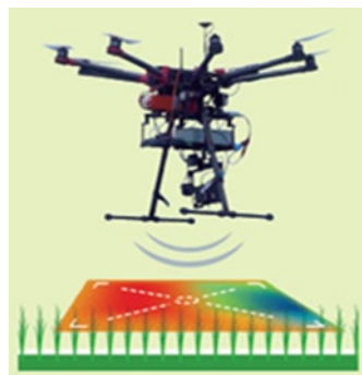
ドローンによるリモートセンシングに基づいた可変施肥
