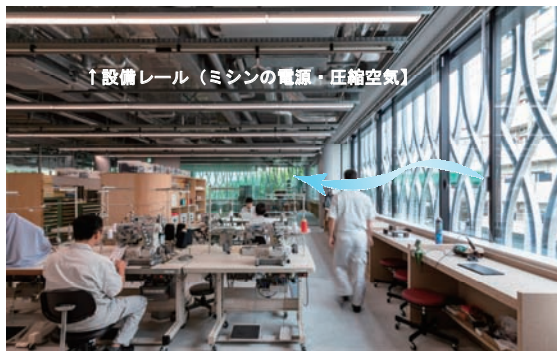
高天井のオフィス、視線制御・自然採光・通風を機能をもつ「環縫いルーバー」
