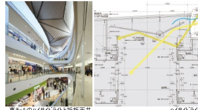
東モールのハイサイドライトと折板天井 ハイサイドライト断面図 エネルギー利用フロー図
