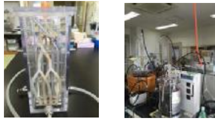
図 2 膜分離可溶化槽外観
