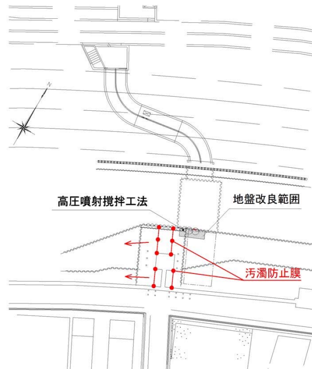
桜島～西島幹線の地盤改良計画平面図
