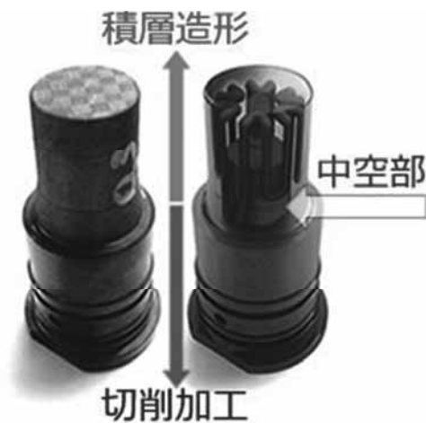
図表 7-2-3 螺旋水管によって、冷却性を高めたハイブリッド金型
