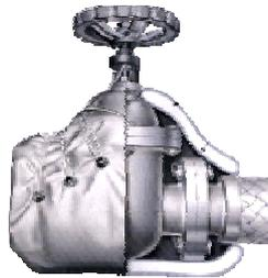
「エネガード」は、井前工業株式会社で製造している配管用脱着式保温材です。ワンタッチで着脱でき、施行時間が大幅に短縮できます。繰り返し使用できるので、ごみも減り経済的です。断熱効果に優れているため、やけど防止や室温上昇を抑えるなど作業環境の改善ができます。
