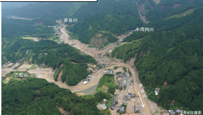
赤谷川、小河内川、乙石川合流点付近における流木による被害(福岡県朝倉市)
