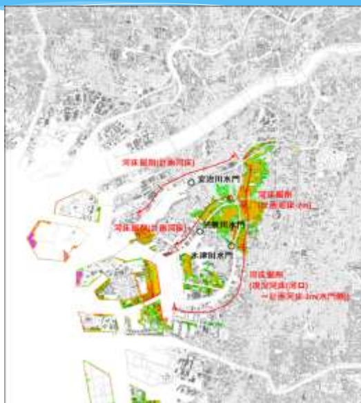
河床掘削②
