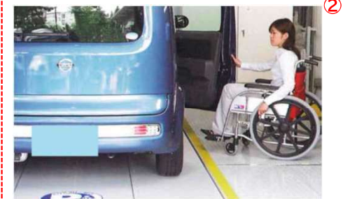
車椅子利用者対応の機械式駐車装置の例 (フルフラット化)
