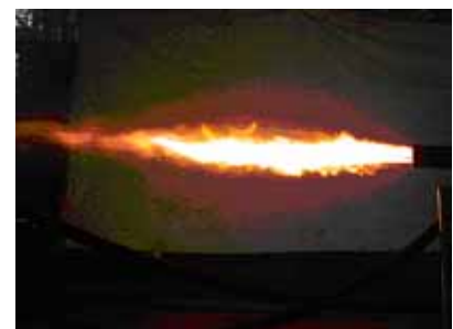
図3 . M C I バーナ燃焼試験
