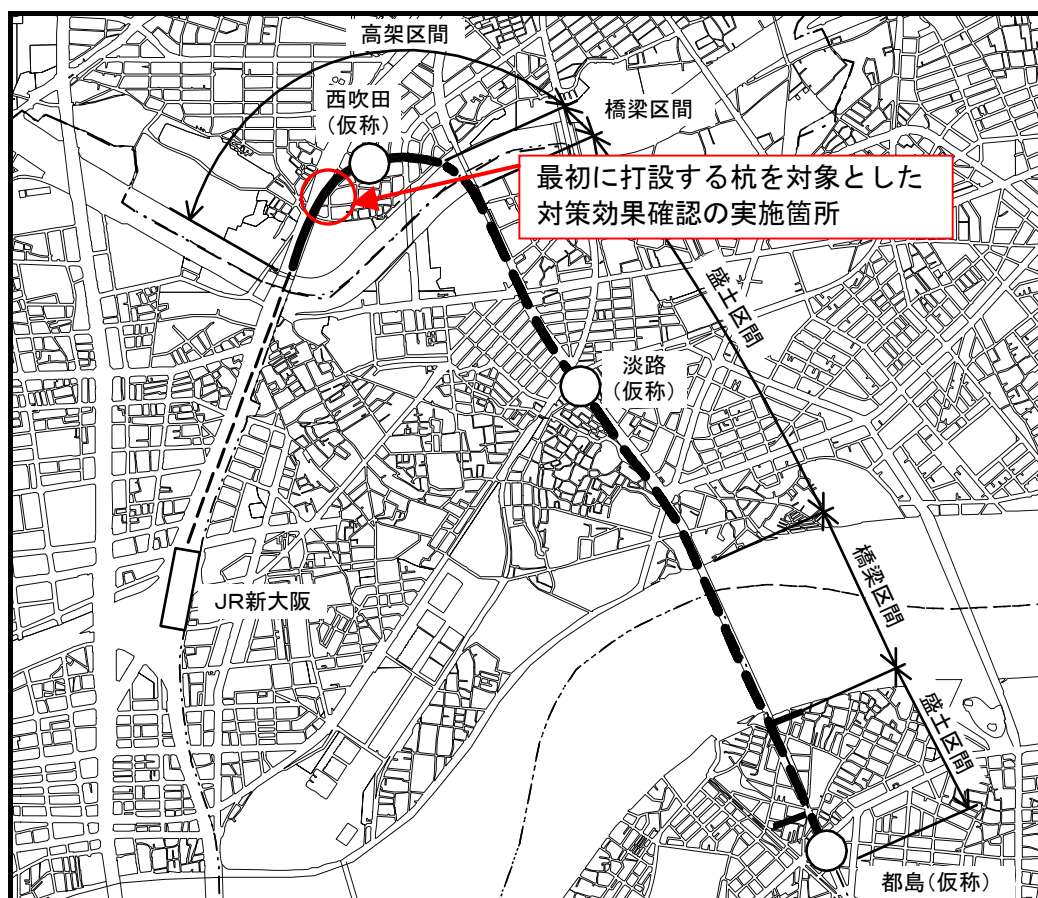
図 1.3.1 最初に打設する杭を対象とした対策効果確認の実施箇所
