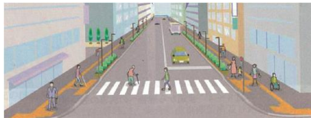
視覚障害者誘導用ブロックの設置
