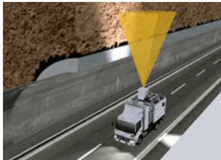
走行型画像計測（トンネル点検）
