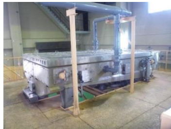
写真 18 省エネ機器の例 (ベルト式ろ過濃縮機)
