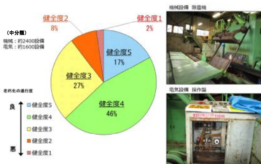
図－6 機械・電気設備の健全度状況（平成 27 年度現在）
