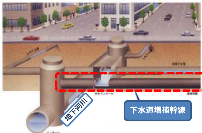
図-10 下水道増補幹線と地下河川
