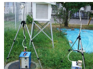
大気中の石綿濃度測定
