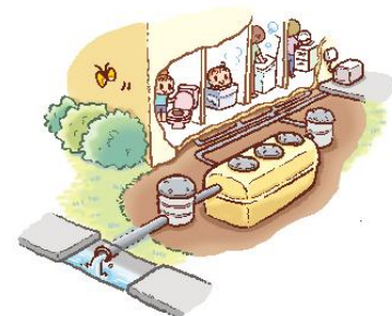
合併処理浄化槽設置イメージ
