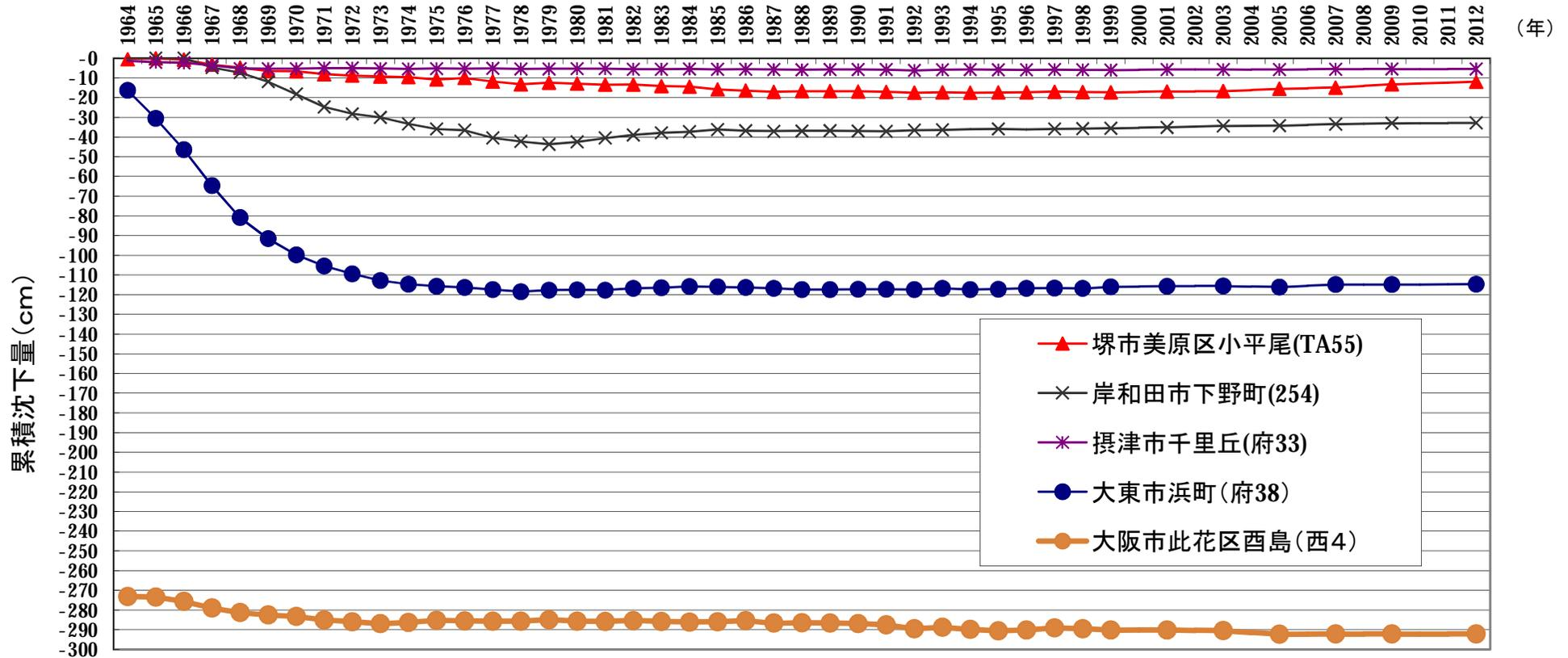
注) 阪神地区地盤沈下調査広域水準測量(1999年より隔年実施)の一環として測量したもののうち、主な地点の地盤沈下の推移を示しています。
