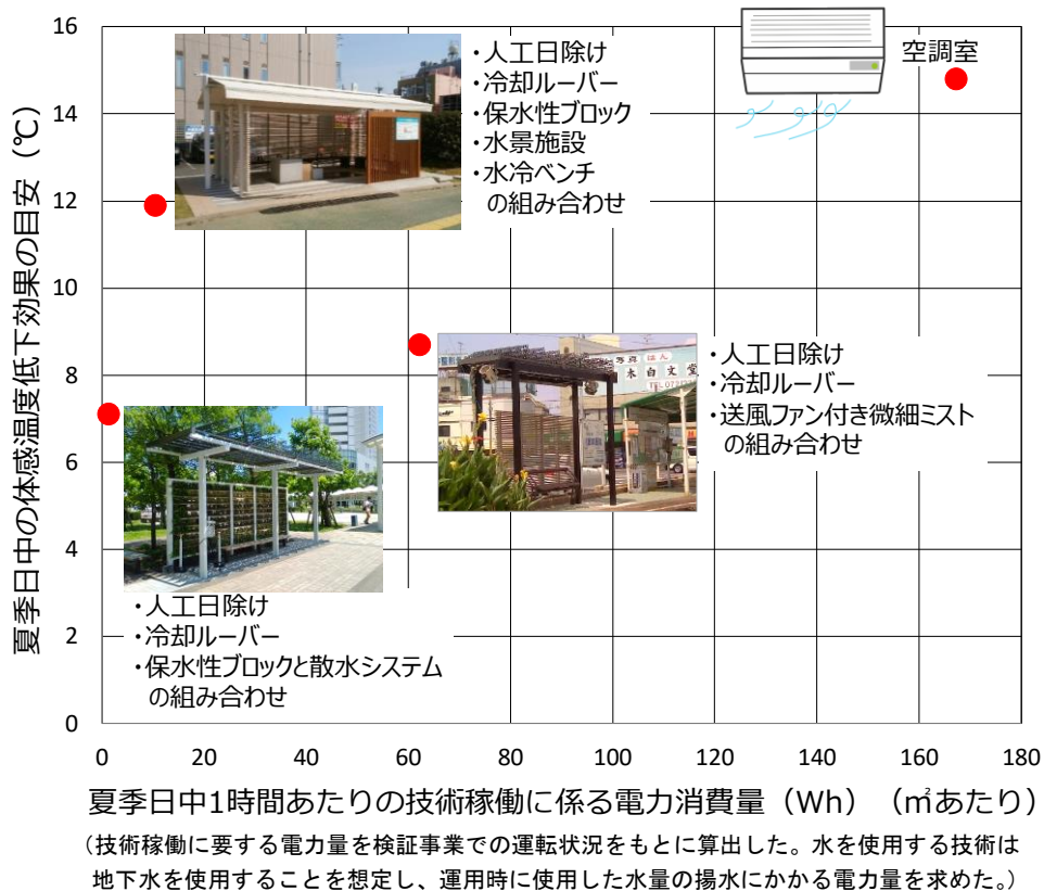
図 2.9 暑さ対策施設での電力消費量と体感温度低下効果の目安（H28 年度環境省検証事業より）
